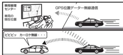
現在、緊急車両の多くはGPSより算出した位置データを無線で定期的（間欠）に各本部に送信するカー・ロケーターシステムを装備しています。
