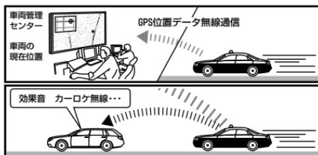
現在、緊急車両の多くはGPSより算出した位置データを無線で定期的（間欠）に各本部に送信するカー・ロケーターシステムを装備しています。
