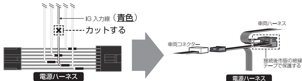
カットした後、必ず電源ハーネス側のIG入力線は市販の絶縁テープを巻いて保護してください。
