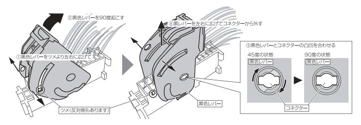
3.コネクター横、下側のロックを細いマイナスドライバー等で溝に合わせロックを少し(約1~2mm程度)持ち上げます。
