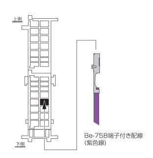
5.コネクターのロックを戻し、黒色レバーをコネクタに取付け、黒色レバーを45度のままの状態でジャンクションブロックに接続し黒色レバーを押し込み元の状態にします。
