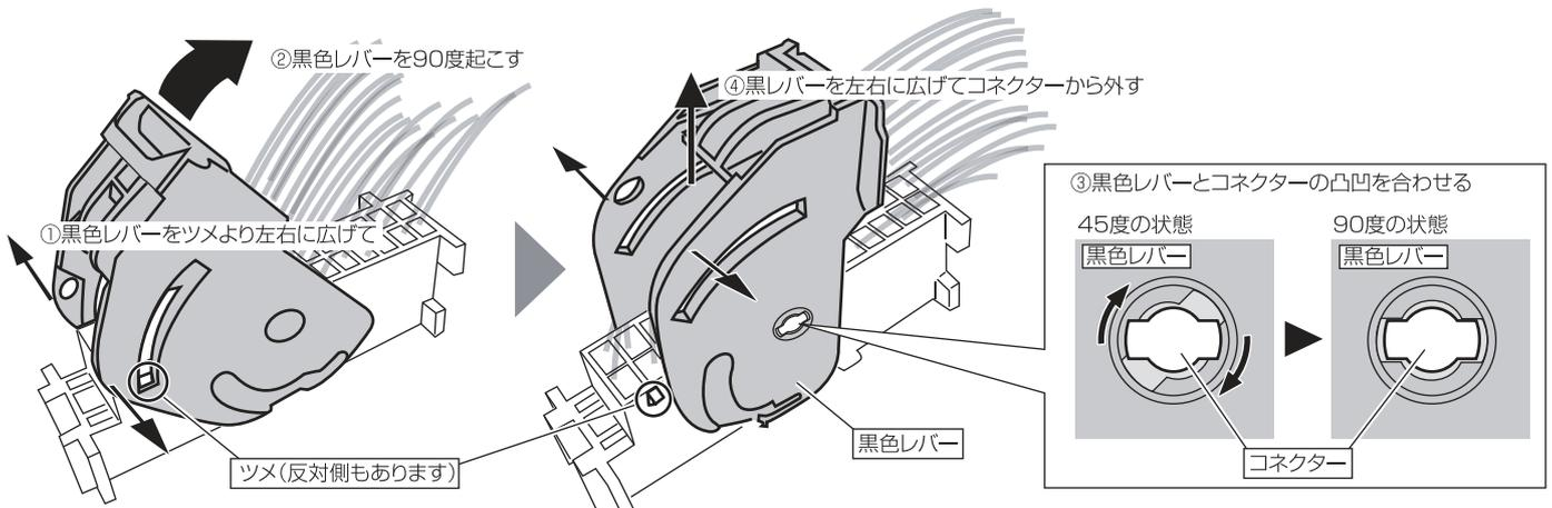
3. コネクタ横、下側のロックを細いマイナスドライバー等で溝に合わせロックを少し(約1~2mm程度)持ち上げます。
