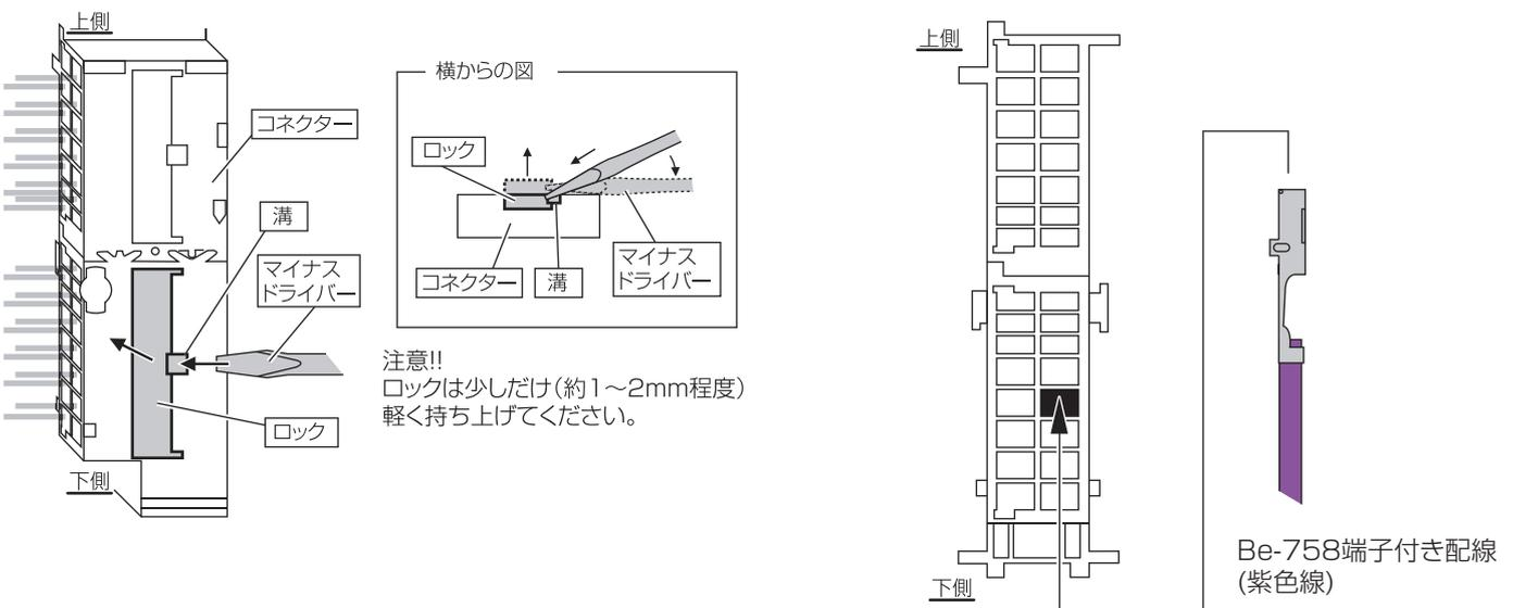
5. コネクタのロックを戻し、黒色レバーをコネクタに取付け、黒色レバーを45度のままの状態ジャンクションブロックに接続し黒色レバーを押し込み元の状態にします。
