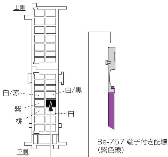
5. コネクタのロックを戻し、黒レバーをコネクタに取付け、黒レバーを45度のままの状態ジャンクションブロックに接続し黒レバーを押し込み元の状態にします。
