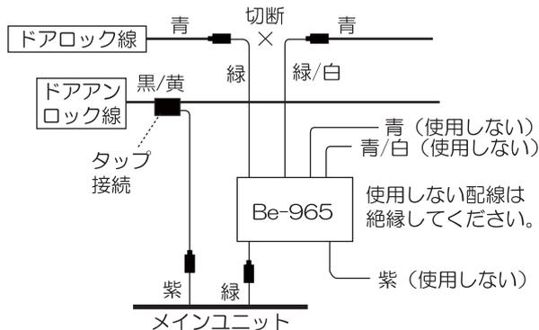
注意！ アンロック接続は配線をカットせずタップでメインユニットから直接、接続してください。
