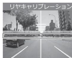
赤線が道路の水平線に合うように調整する。
