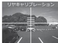
4. リヤカメラの取付向きを調整 (⇒ P23) し、黄色の縦線が車線の中心に合う様に左右方向の調整を行います。
