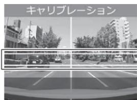
道路の水平線が、2本の横線内に収まる様に調整する。
