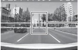
赤の縦線が車線の中心に合うように【アップ】【ダウン】や本体の向きで調整する。
