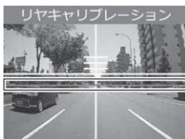
赤線が道路の水平線に合うように調整する。
