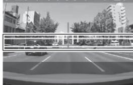
道路の水平線が、2本の横線内に収まる様に調整する。
