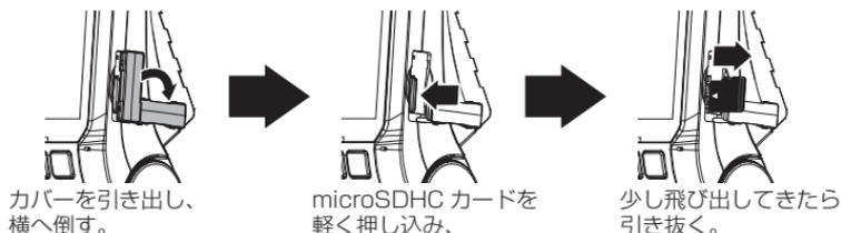
※ 挿入する時は逆の手順で行なってください。また必ず液晶側に microSDHC カードのロゴが見えるように挿入してください。逆向きに無理矢理挿入すると破損します。
