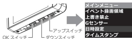
3) 【アップ】【ダウン】で設定し、【OK】で次の項目に移動します。日時変更後【設定】で【OK】を押す
