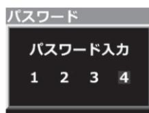
3) 2) を繰り返し4文字のパスワードを入力し【OK】を押すと、確認画面が表示されるので再度設定したパスワードを入力し【OK】を押すことで設定完了です。
