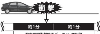
衝撃を検出した時点のファイルと次のファイルの合計 2 分を駐車監視衝撃録画データとして保存します。
