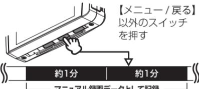
スイッチを操作した時点のファイルと前のファイルの合計 2 分をマニュアル録画データとして保存します。
