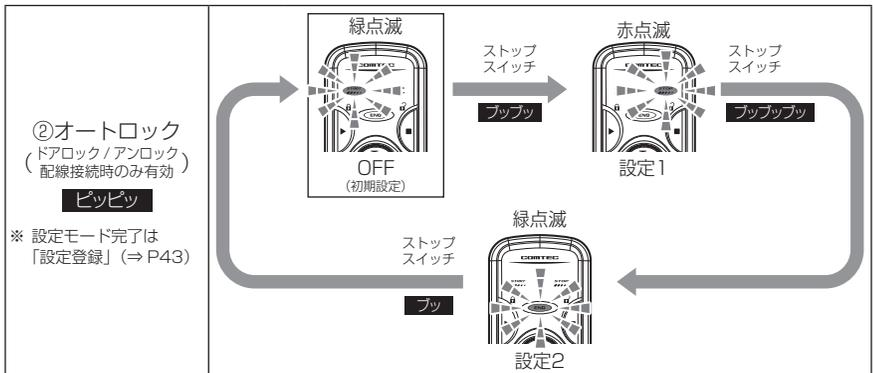
設定 1・・・ リモコンでアンロック後、約 30 秒以内に手でエンジン始動するか、ドアを開けると、オートロックを解除します。別売品 SS-051「カーテシ配線（複数線）」が必要です。(⇒ P35,36)
