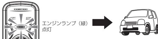
※ アンテナユニットがリモコンからの電波を受信できなかった場合は、リモコンのエンジンランプ (緑) は点灯しません。(アンサーバック音をメロディまたは、ブザーに選択されている場合は NG 音が鳴ります)
