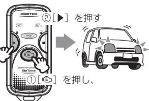
4. エンジンスターターのリモコンでエンジンを始動 (⇒ P41) し、ヘッドライトが点灯することを確認してください。
