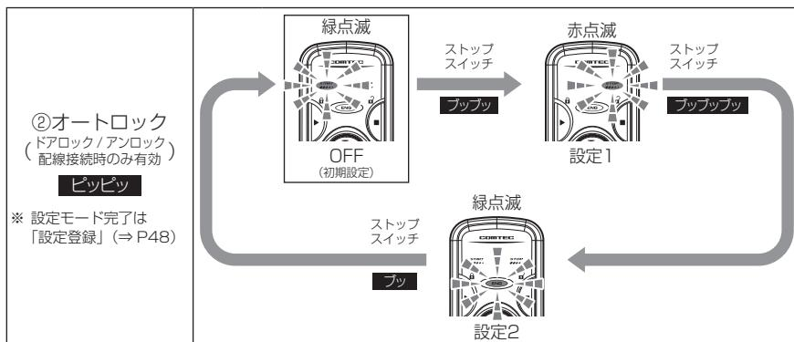
設定 1… リモコンでアンロック後、約 30 秒以内に手動でエンジン始動するか、ドアを開けると、オートロックを解除します。別売品 SS-051 「カーテシ配線（複数線）」が必要です。(⇒ P39,40)
