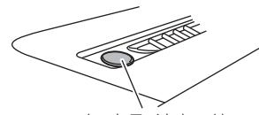
2. ダッシュボード上やフロントガラスなどにあるオートライトセンサーを探し、センサーが反応するようにシートなどで覆って暗くしてください。
