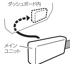
※ 一度貼り付けた後、車両から剥がすと両面テープの粘着力が極端に落ちます。
