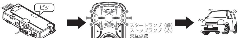
\*アンテナユニットがリモコンからの電波を受信できなかった場合は、リモコンのスタートランプ（緑）とストップランプ（赤）は交互点滅しません。（アンサーバック音をメロディまたは、ブザーに選択されている場合はNG音が鳴ります）
