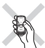
●アンテナを伸ばさずに操作すると通信距離が短くなります。
