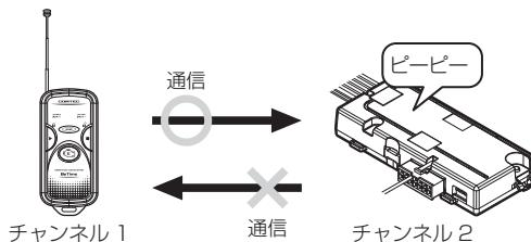
※ 通信周波数切替方法の設定で設定登録後リモコンへのアンサーバックが NG になってしまった場合にリモコン単体のみ周波数切替を行います。
