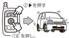
4. エンジンスターターのリモコンでエンジンを停止させてください。(⇒ P48) この時、エンジンが停止し、ヘッドライトが消灯すれば正常です。
