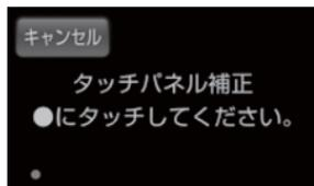
3. 補正が終了すると、[補正終了画面]が表示されますので左下・右上の【●】をタッチし、確認をした後、【終了】をタッチする
