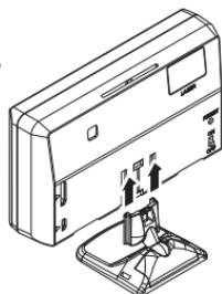
3. 濡れたタオルなどでダッシュボードを拭き、きれいにしてから固定します。下図Ⓐ、Ⓑ、Ⓒのようにレーダー本体が垂直で車両の進行方向を向くように調整します。
