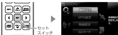
2. 【アップスイッチ】【ダウンスイッチ】を押し、メニュー項目を選択し、【セットスイッチ】を押し決定する
