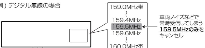
※キャンセルした159.5MHz以外の159.0～159.4MHz、159.6～160MHzを受信するとキャンセルされずに警報を行います。
