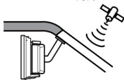
◇GPSアンテナがミラーで隠れている
