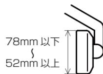
※GPSアンテナに純正ミラーが被らないように取付けを行ってください。
