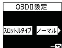
4. 【バックスイッチ】を 3 回短押しし、待機画面に戻ります。
