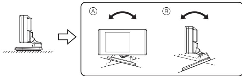
4. レーダー本体後部が、車両の進行方向に向くように調整します。
