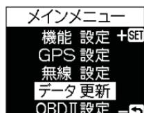
5. 現在の GPS データの情報が表示されるので、【ネクストスイッチ】を押すと、データ更新が開始される
