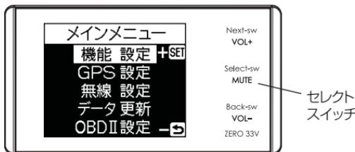
2. 【セレクトスイッチ】を短押ししてメニュー項目を選択し、【ネクストスイッチ】を短押しして決定します。
