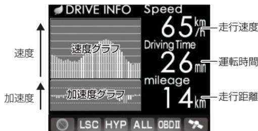
◇グラフの色は速度変化・加速度変化の大きさを表わしています。
