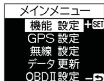
4. 【セレクトスイッチ】で【データ更新】を選択し、【ネクストスイッチ】を押して決定する
