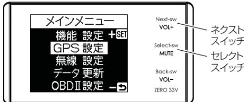
3. 【セレクトスイッチ】を短押しして設定変更する項目を選択します。
