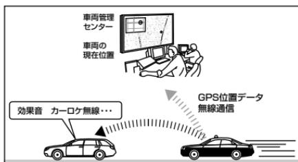
現在、緊急車両の多くはGPSより算出した位置データを無線で定期的（間欠）に各本部に送信するカーロケターシステムを装備しています。
