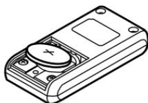
**4** 電池カバーを矢印の方向へスライドさせて取付けます。
