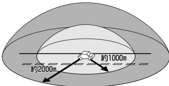
※ 受信感度（距離）は直線見通し距離で、間に障害物が無い状態での受信距離目安です。
