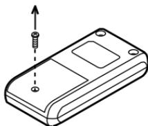
**2** 電池カバーを矢印の方向へスライドさせて外します。
