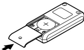
**5** 電池カバーのネジを締めます。
