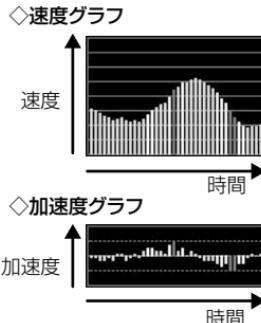
◇グラフの色は速度変化・加速度変化の大きさを表わしています。
