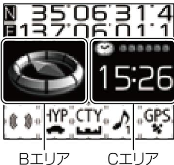
▶ コンパス ▶ 速度 ▶ 時計 ▶ 車両電圧 ▶ GPS 情報
