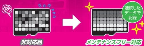
本製品の専用ファイルシステムは、パソコンなどで使用されているファイルシステム(FAT等)に比べ、microSDカード内データの断片化が起りにくいファイルシステムとなっています。そのためmicroSDカードを定期的フォーマットせずに使用することができます。
